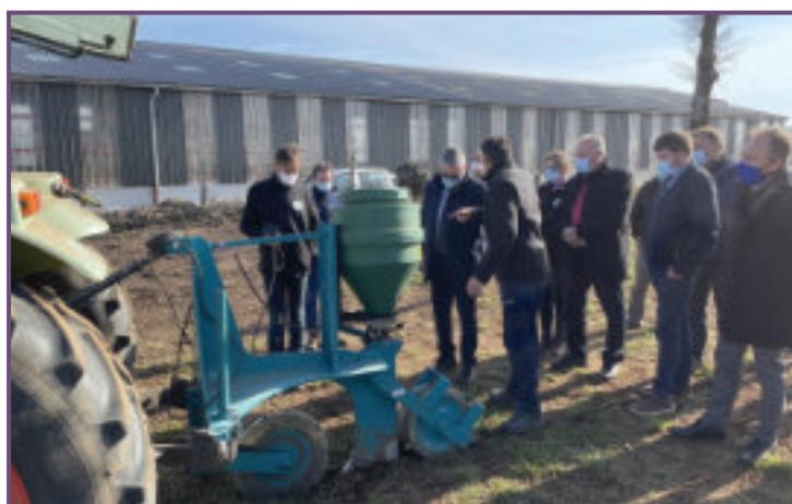
Démonstration de l'utilisation d'une charrue-taupe à soc creux pour mécaniser la lutte contre le campagnol terrestre.
